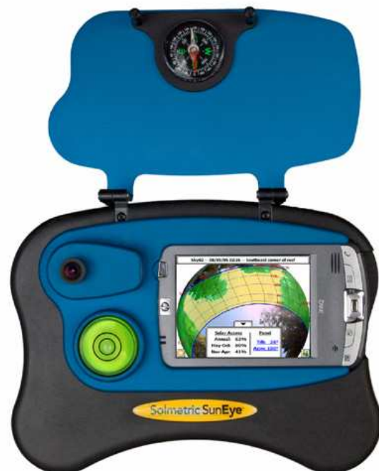
Bild 8: SunEye, professionelle Erfassung der Horizontverschattung
