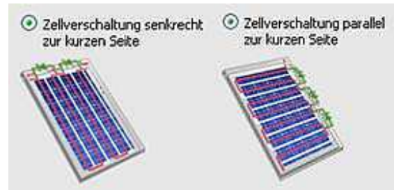
Bild 5: Definition der internen Zellverschaltung
